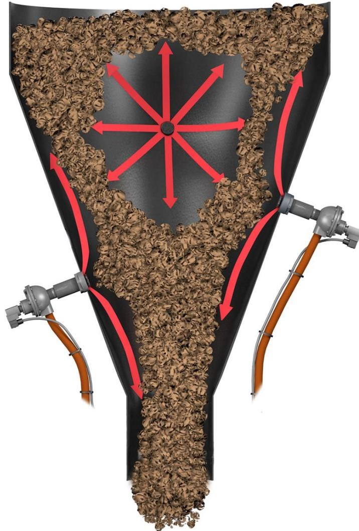
Cada boquilla **AirSweep®** dirige una ráfaga de aire comprimido o gas inerte de alta presión y alto volumen en 360° a lo largo de las paredes interiores de los equipos o recipientes de proceso, rompiendo la fricción para levantar y barrer el material estancado nuevamente dentro de la corriente de flujo.
